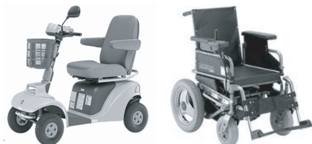
図1：スクータータイプ（左）及びジョイスティックタイプ（右）電動車いすの例
