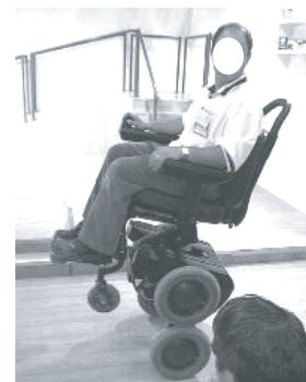
図 8: 階段昇降も可能な市販 (米国) の電動車いす (インディペンデンス・テクノロジー社: INDEPENDENCE 3000 IBOT Transporter)
